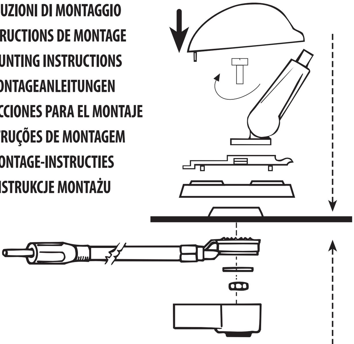
**IT** Prima di installare l'antenna verificare che il foro per il fissaggio sul tettuccio dell'auto sia di 9 mm e che la misura della base dell'antenna originale sia uguale o inferiore 3,5x4 cm
